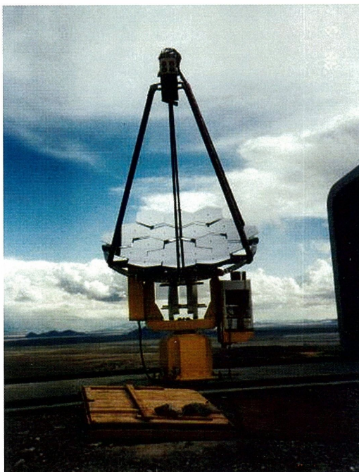
図19：7 素子宇宙線望遠鏡の 1 素子。TA 計画の試作機として経緯台付きで開発されました。
