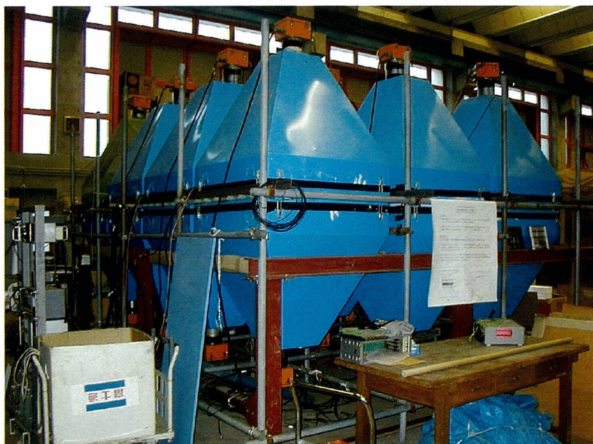
図17：レッドバーガー実験装置（中央実験棟、12m 2 ）。空気シャワーの元となった一次宇宙線の組成を調べるために、空気シャワー中の電子成分、ガンマ線成分、ミューオン成分を分離して測定します。
