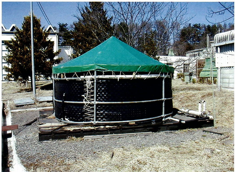
図18：水チェレンコフ検出器（中央実験棟、面積10m 2 深さ1.2mの水タンク）。
