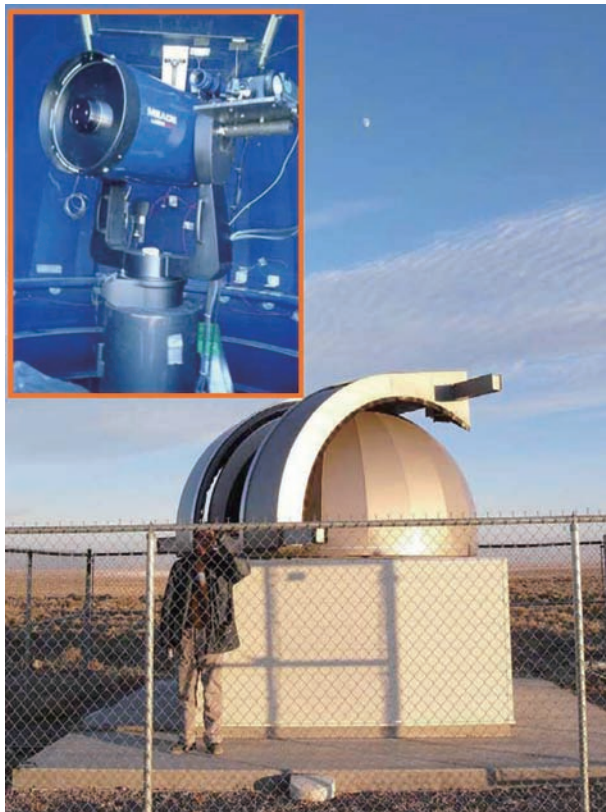
図9 BRMのFDステーションに設置したライダードーム。左上にドーム内に設置したライダーシステムを示す。
