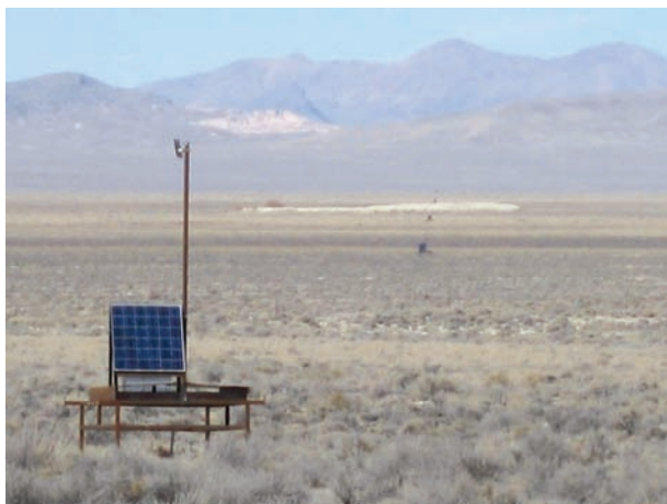
図5 設置した地表粒子検出器。右後方に隣の検出器が見える。
