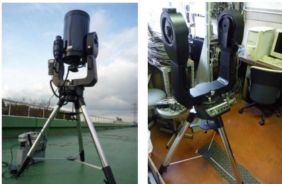
図 3.1: (左)MEADE 製 望遠鏡付経緯台 (LX200ACF-25) , (右) 鏡筒を取り外した状態
