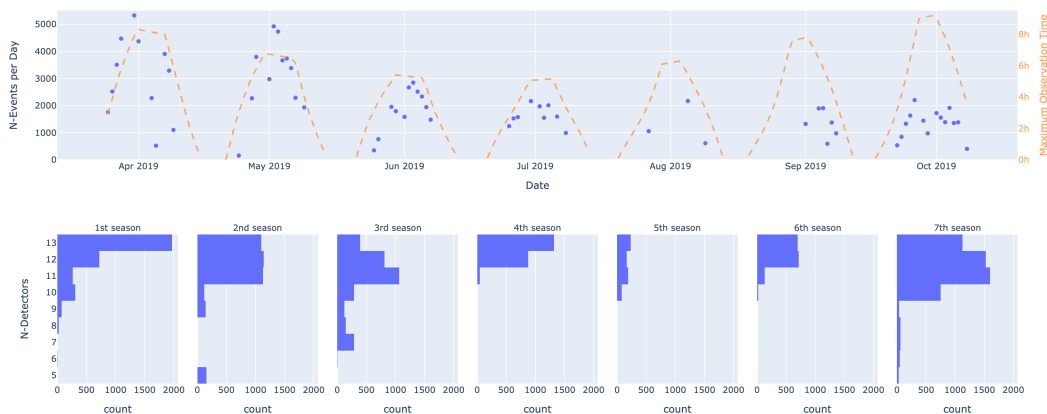
図 6.1: 上図では、橙色破線が予定されていた観測時間で、青丸が NICHE 実験で観測された日毎のコインシデンスイベント数。下図は、シーズン毎に分けてプロットした分毎に同時に稼働していた検出器台数のヒストグラムであり 5 台以上の検出器台数のみを示している。
