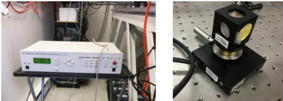
図 1.16: 脱偏光試験装置（左: 制御装置, 右, 偏光プリズム）
