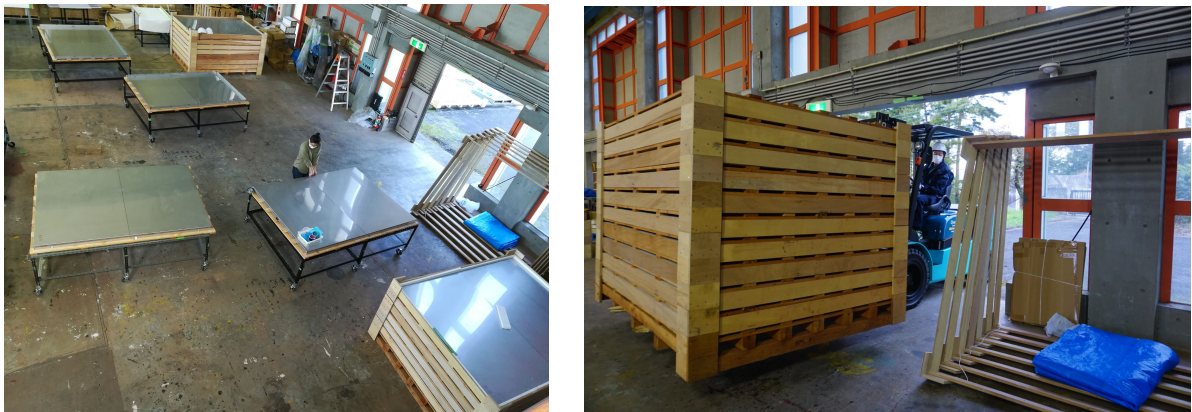
図 3.3: 左：テスト通過後、ステンレス製の蓋で閉じられたシンチレーション検出器。右下と上側に積み上げられた検出器がある。右：積み上げられた検出器。
