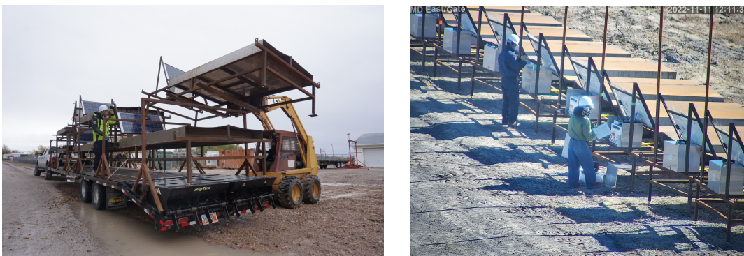
図 3.7: 左：トレーラーに積まれた SD。1 度に 6 台の SD を積むことが可能。右：運ばれてきた SD の 1 MIP テストをしている様子。この写真は TA MD に設置された定点カメラによって撮影された。中心に写っているのが本論文の著者である。
