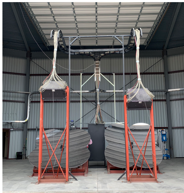
図 2.4: TALE FD カメラと鏡。左は上側を、右は下側を観測する。鏡で反射した光子を手前にあるカメラで観測する。
