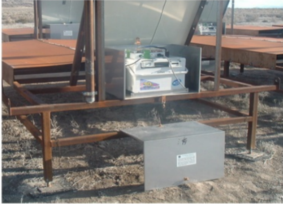
図 2.10: ソーラーパネルの裏の箱に SD エレクトロニクスとバッテリーが格納されている (エレクトロニクス格納箱のふたを外したところ).
