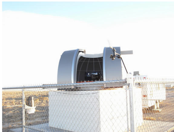
図 3.12: LIDAR ドーム。中にある望遠鏡にはレーザーと PMT が取り付けられている
