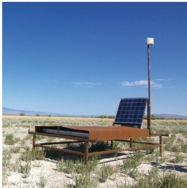
図 3.13: 現地に設置されたシンチレーション検出器
