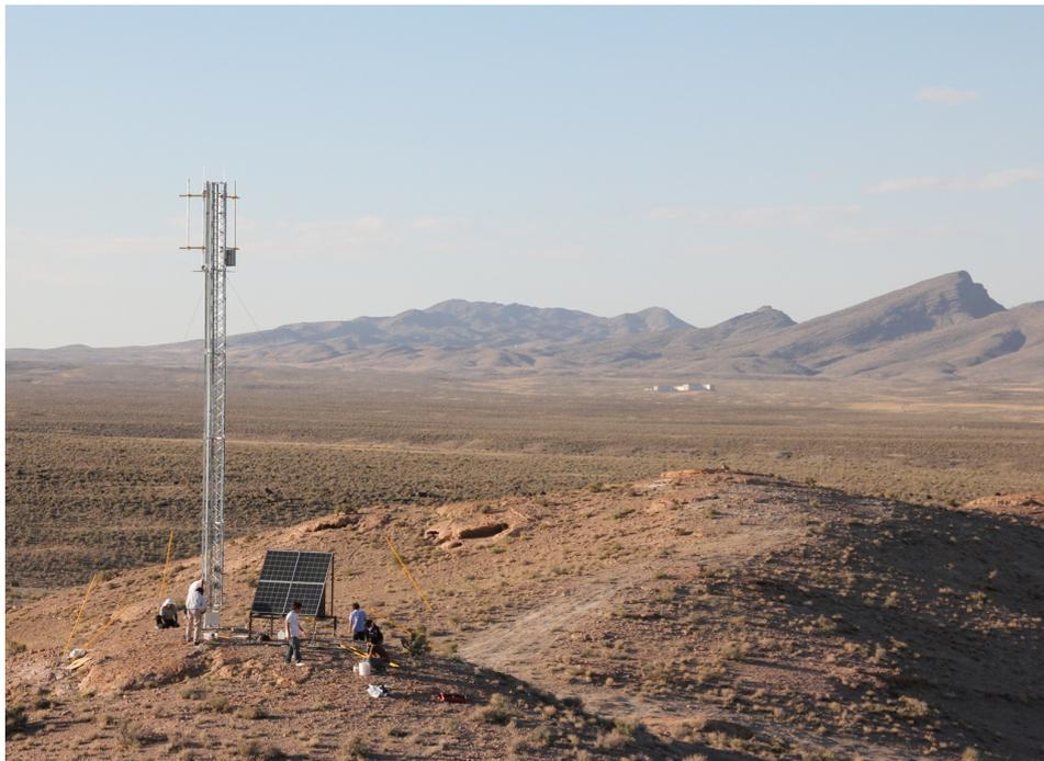
図 2.10: TALE 実験用のデータ通信塔。ソーラーパネルを用いて電力を供給している。中央右奥の白い建物は TA-MD/TALE-FD ステーションである [27].
