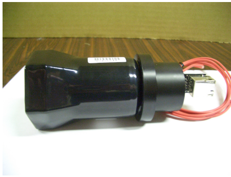
図 2.4: 写真が実際に使用される PMT(HAMAMATSU R6234)。
