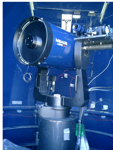
図 3.28 LIDAR ドーム内の 30cm 反射型望遠鏡。この望遠鏡で後方散乱を観測する。望遠鏡の右側に付いているのが YAG レーザーである。
