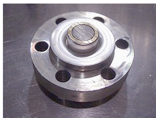
図 4.9 カソードアセンブリを電子銃のステムに取り付けた所。フランジによって固定される。
