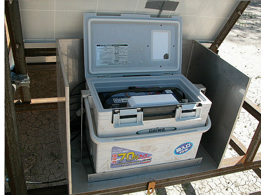
図 3.6 SD のソーラーパネルの裏側。バッテリーの入ったクーラーボックスと SD コントロール用エレクトロニクスが設置される。
