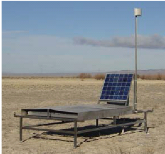
図 3.5 SD の外見。台の上にシンチレータの入った箱、ソーラーパネル、無線 LAN 用アンテナが設置されている。
