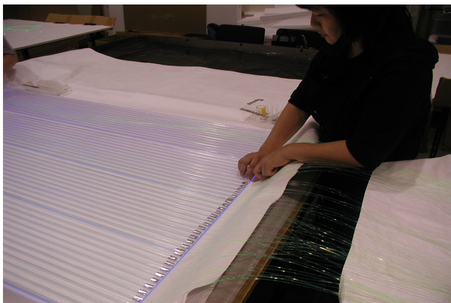
図 22: シンチレーターにファイバーを取り付けている図
