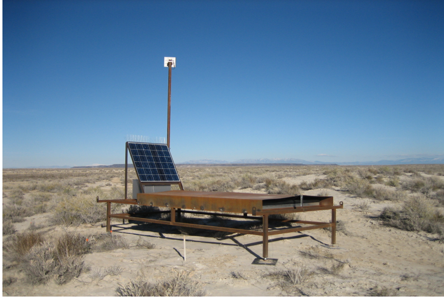
図 20: サイトに設置した TA 地表粒子検出器
