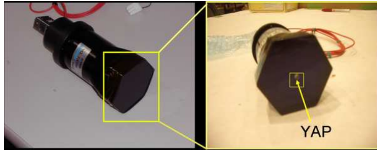
図 3.7: YAP。PMT 前面中央に設置し、絶対光量光源として用いる。
