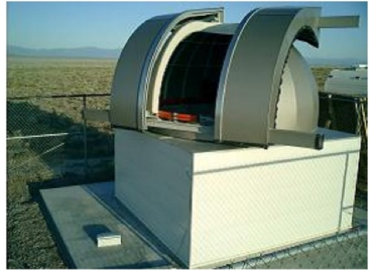
図 3.25: LIDAR ドームの概観。観測時にドームが開き 1Hz でレーザーを打ち大気の状態を測定する
