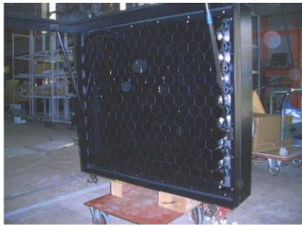
図 3.16: 256 本の PMT で構成されているカメラ。
