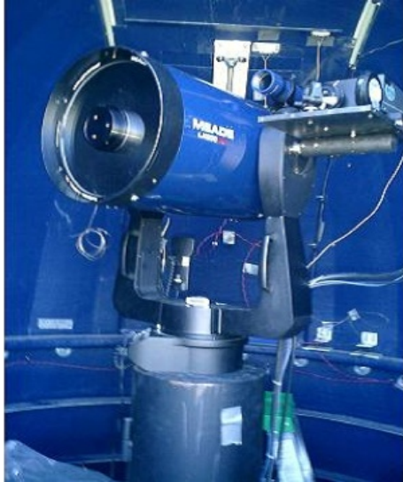
図 3.24: LIDAR システム。中央の反射型望遠鏡が後方散乱光を中央に設置してある PMT に集光する
