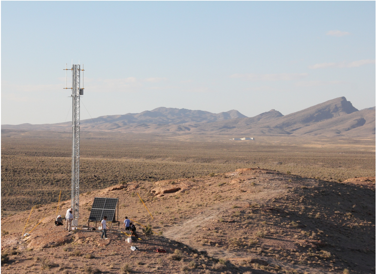
図 2.8: TALE 実験用のデータ通信塔の外観。電力源は太陽光パネルによる発電である。中央の右奥に MD/TALE-FD ステーションが写っている。
