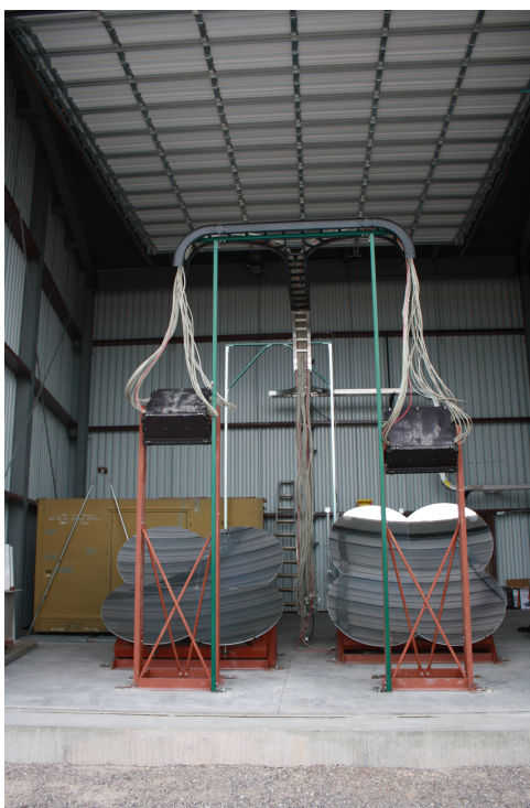
図 2.3: TALE 実験の FD の外観。左は上側視野を、右は下側視野を観測している。それぞれ搭載されている鏡は、半径 630 mm の円形のセグメントミラー 4 枚からなる面積 4.18 \text{ m}^2 のクローバー型の合成球面鏡である。
