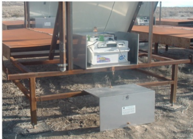
図 2.9: ソーラーパネルの裏の箱に SD エレクトロニクスとバッテリーが格納されている。
