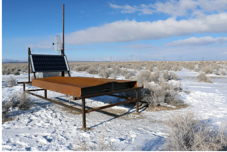
図 2.8: 設置されている TA×4 実験の地表検出器 (SD)。茶色の屋根の下にシンチレータボックスが格納されている。
