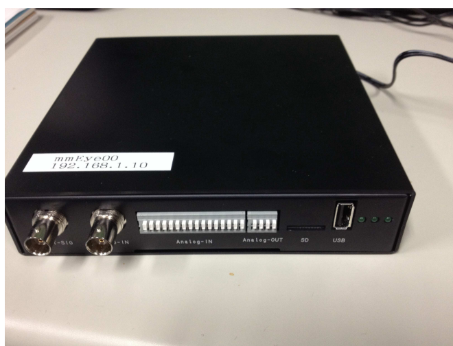
図 3.1: 測定ユニット：表 3.1 のように仕様を決定し、ブレインズ社に作成を委託した。
