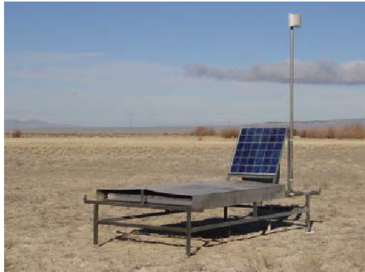
図 2.6: 現在設置されている TA 実験 SD。茶色の屋根の下にシンチレータボックスが格納されている。
