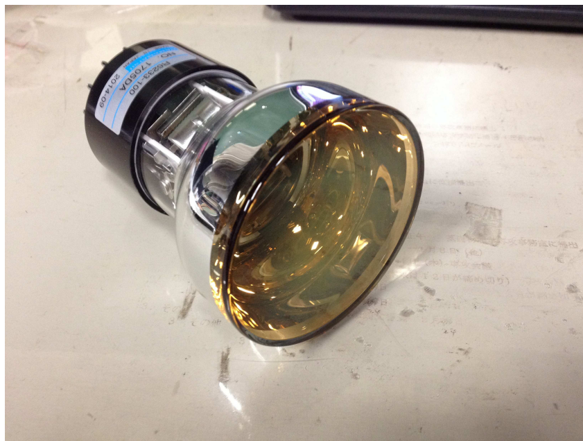
図 3.8: PMT 写真：受光面の直径は 3 インチ。
