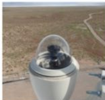
図 3.2: CCD カメラ外観.24 時間屋外に設置するためアルミニウム合金製ハウジングドームにカメラ等物品を格納している. カメラレンズを保護するためにハウジング上部は透明なアクリルカバーとなっている.
