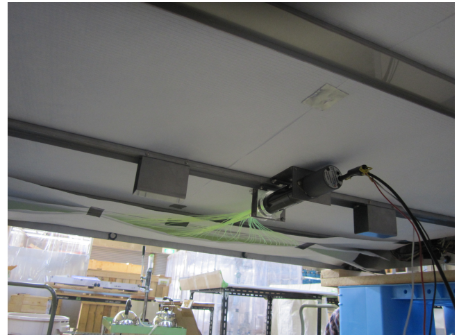
図 6.1.8: 鉛サンドイッチ型 SD を逆さにした様子
