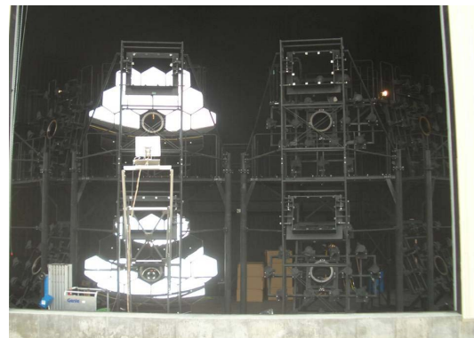
図 3.5: FD ステーションの写真(左)および望遠鏡架台の写真(右)
