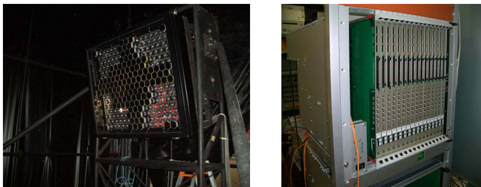
図 5.2: 明野試験で用いた PMT カメラ (左) 及び読み出しトリガー電子回路 (右)
