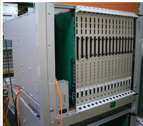
図 3.23: TF と SDF16 枚が VME クレーンに挿入されている様子
