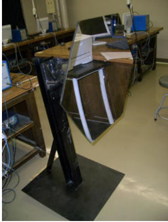
図 2.7: 鏡試験装置。セグメントミラーに拡散光を照射し反射光をスキャンしスポットサイズを測定する。スポットサイズが極小となることを曲率半径とする。
