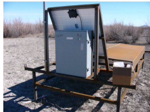
図 2.24: 地表検出器を背面から見た図。ソーラーパネルの後ろにエレクトロニクスの入っている箱が取り付けられている
