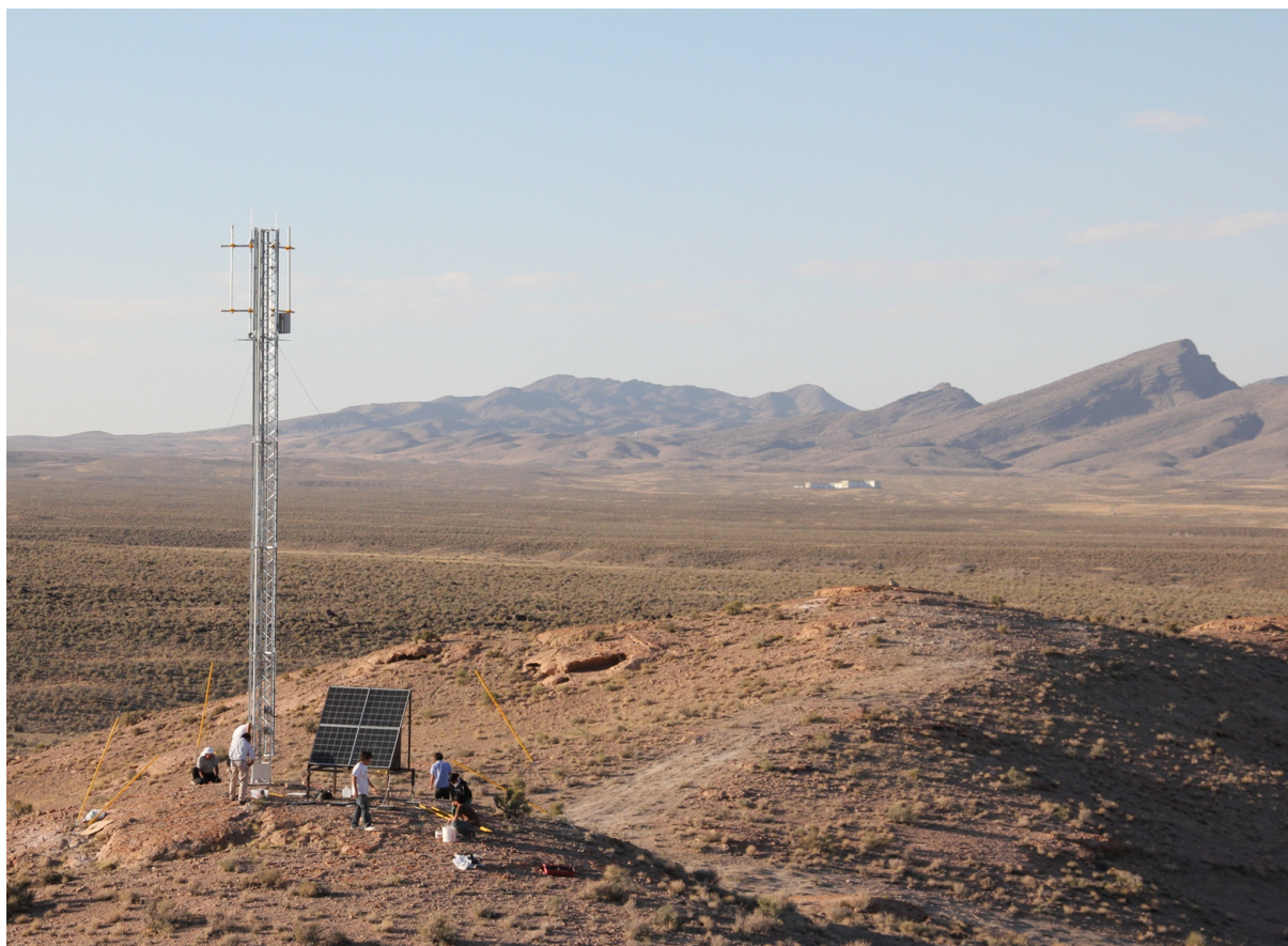
図 2.11: TALE 実験用のデータ通信塔。太陽光パネルにより必要な電力を得ている。中央右奥に MD/TALE-FD ステーションが小さく写っている。
