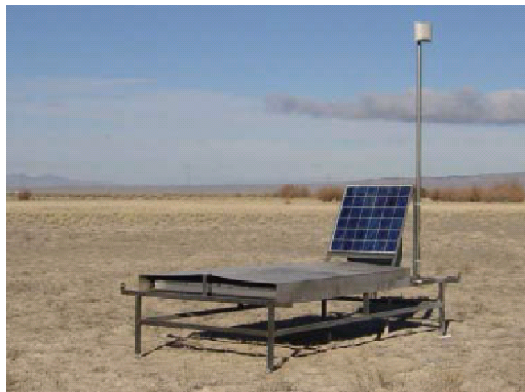
図 2.6: 現在設置されている TA 実験の SD。茶色の屋根の下にシンチレータボックスが格納されている。
