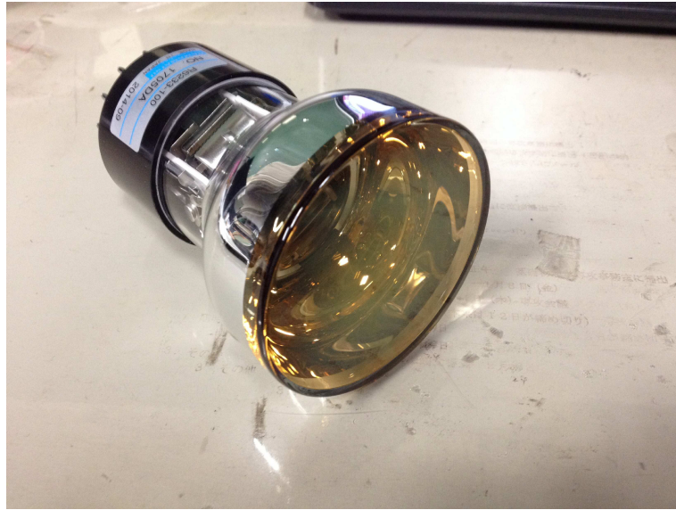
図 3.8: PMT の写真 : 受光面の直径は 70mm
