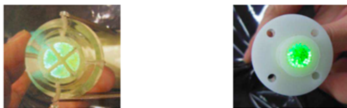
図 3.2: ファイバーの端を束ねて端面を PMT の入射ガラス窓に接触させて固定する道具 (クッキーと呼ぶ) (左) これまで用いていたクッキー。透明な材料でできているので光が一部逃げてしまっていた。(右)TAx4 で用いるクッキー。白い材料で光を反射させてロスを減らすことが可能になった。
