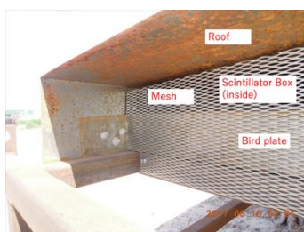
図 5.1: TAx4SD のシンチレータボックス部を横から見た写真。シンチレータボックスに屋根を取り付けると横に隙間ができ野鳥が入りこんでしまうため、金属製の板とメッシュを取り付けた。
