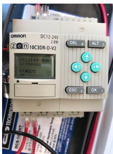
図 5.2: 新しく使われた Reboot Timer(オムロン社製 ZEN-10C3DR-D-V2)
