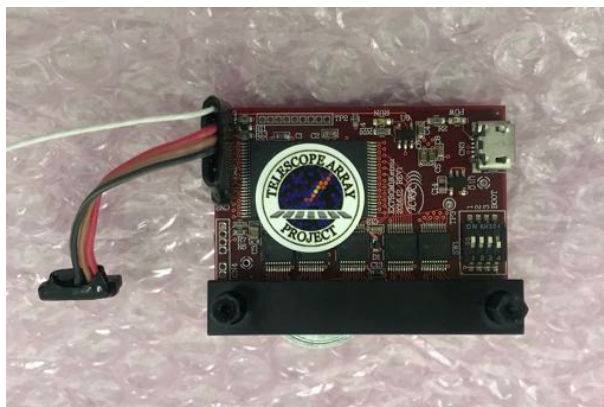
図 4.42: メインボードに取り付けて使う外付け ROM。テスト用のファームウェアが書き込んである。
