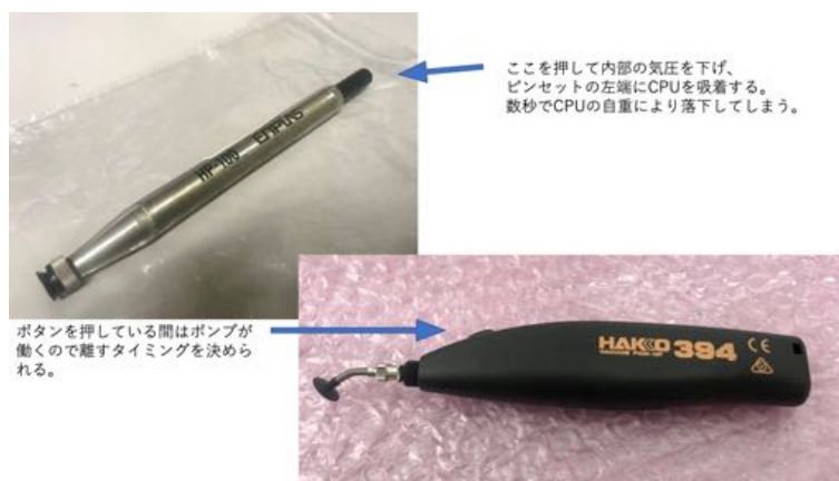
図 4.43: 変更前の吸着ピンセット (左上) と変更後の吸着ピンセット。
