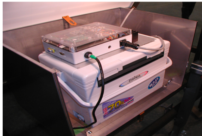
図 2.4: ステンレスボックスの中。クーラーボックスの中にはバッテリー、Reboot Timer、スイッチボードが収納してある。クーラーボックスの上にはエレクトロニクスが固定されている。
