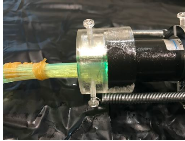
図 4.6: ファイバーは接着せず、PMT の光電面に接触させて隙間はグリースで埋める。
