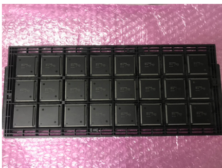
図 4.40: エレクトロニクスに組み込む前の CPU。写真のプレートに乗った状態から次の図 4.41 に示すテスト用ボードに吸着スポイトで載せる。
