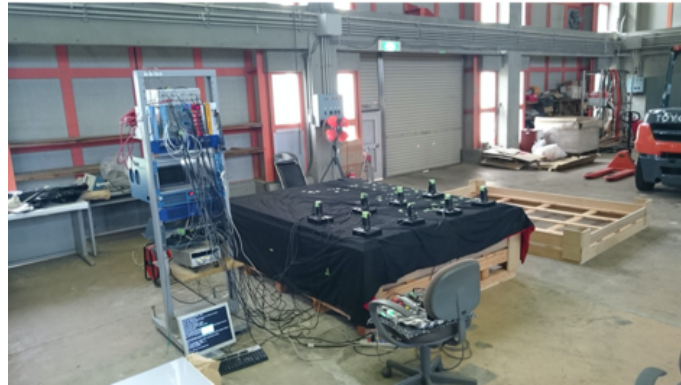
図 4.26: 作業風景。黒いシートの下に SD のシンチレーションカウンタがある。シートの上に 15cm×15cm のプローブが 8 個置いてある。
