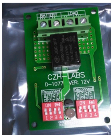
図 5.3: TAx4SD で新しく使われた Low Voltage Disconnect Module(LVDM)。disconnect と reconnect の電圧を選ぶスイッチがある。
