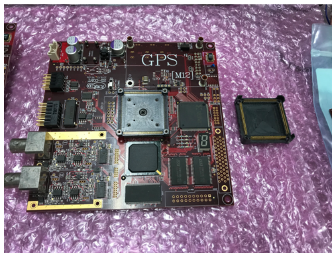
図 4.41: CPU チェック用メインボード。中央のソケットに CPU を置き、右の蓋を被せて締めるとピンが通電するように作られている。
