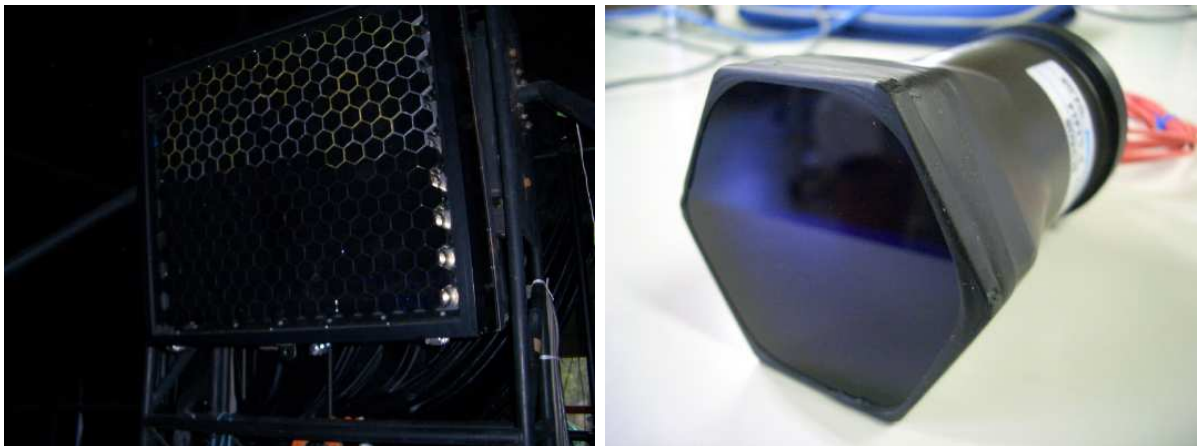
図 2.18: PMT カメラ (左) と BG3 が取り付けられた PMT(R9508)(右).
