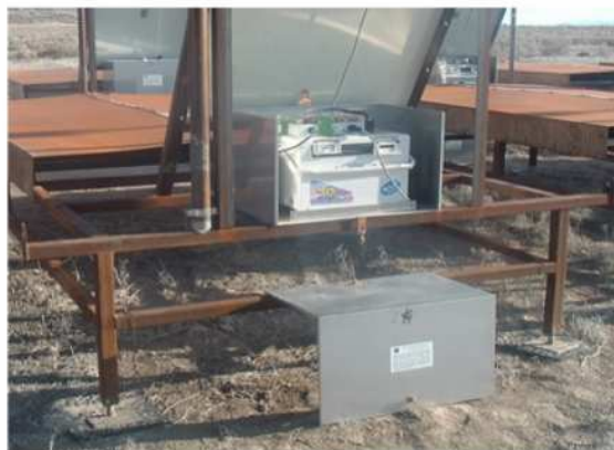
図 2.3: ソーラーパネルの下の箱にエレクトロニクスとバッテリーが収納されている。
