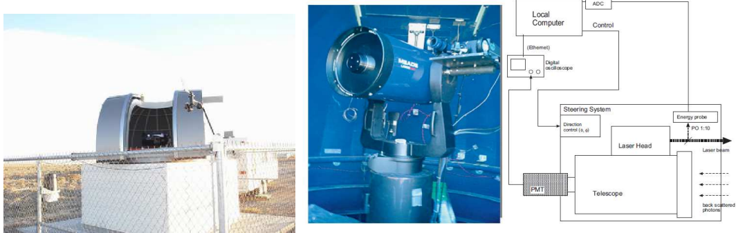
図 2.28: LIDAR ドーム (右) とドーム内部の装置 (中). ドームの中にある望遠鏡にはレーザーと PMT が取り付けられている (右).
