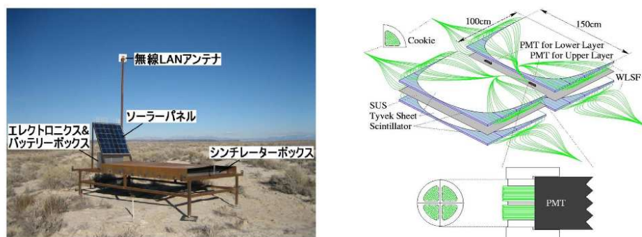
図 2.2: TASD. 左は現地に設置したSDの写真。右はシンチレータ等の設置図。
