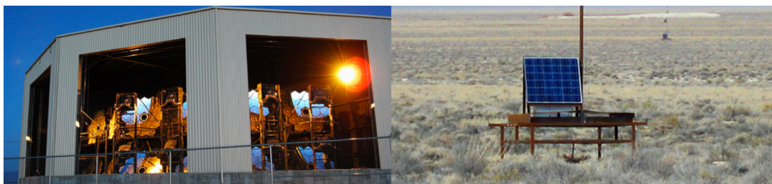
図 1.6 大気蛍光望遠鏡 (左) と地表粒子検出器 (右) の外観 [6]
