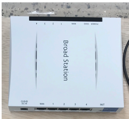
図 3.6 自律観測試験に使用したルーター
