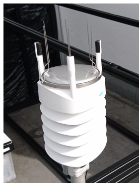
図 4.1 CRAFFT 試験機に実装された WXT ウェザートランスミッタ
