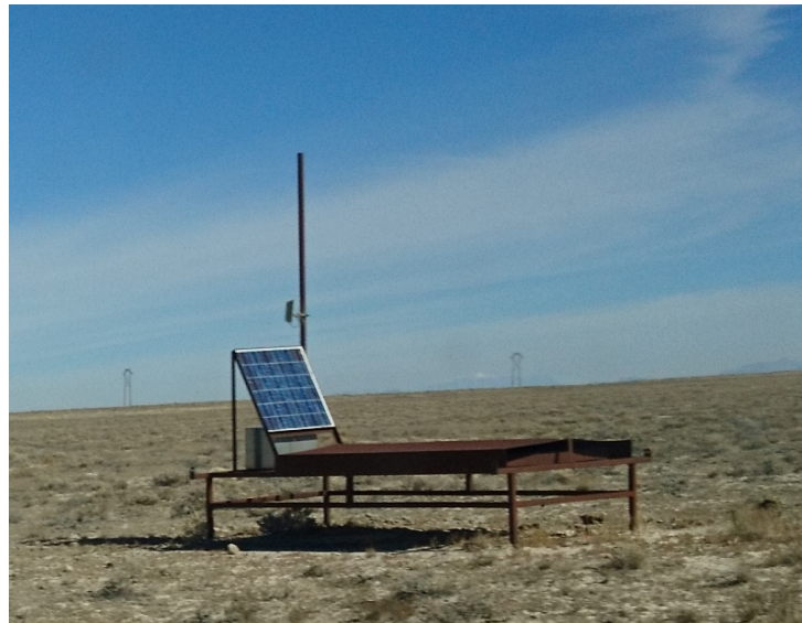
図 1.8 TA 実験で使用されている地表粒子検出器
