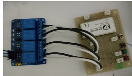
図 3.22 シャッター制御用回路写真
