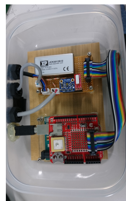
図 4.5 Arduino との接続の様子
