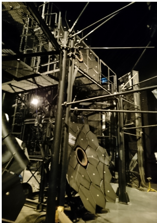
図 1.7 TA 実験で使用されている大気蛍光望遠鏡
